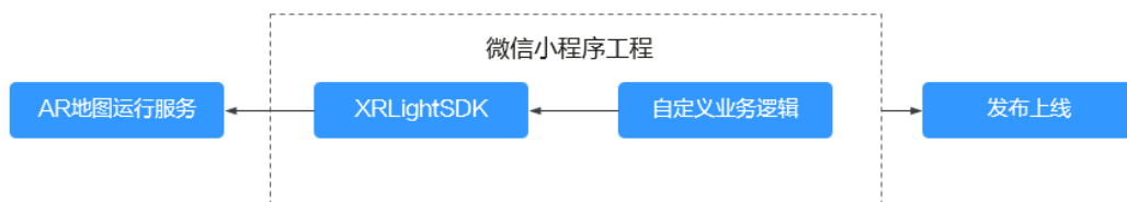
图 3-1 XRLightSDK 工作原理
